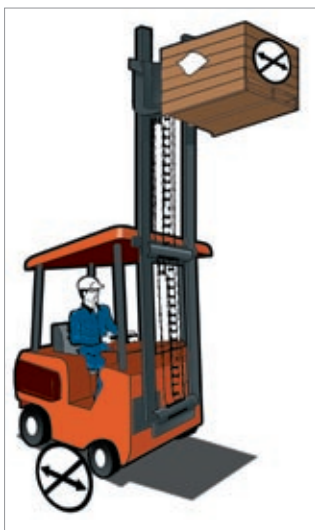
Figura 1 No circular con cargas elevadas.
