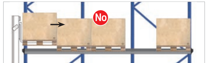
No empujar los pallets con el autoelevador
