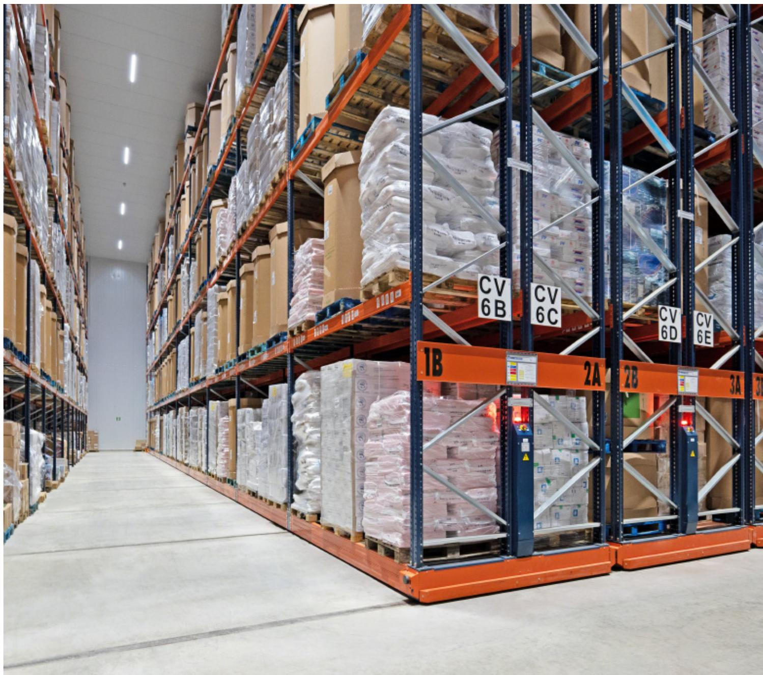
niveles, y reposan sobre bases móviles que se desplazan lateralmente de forma autónoma. Este sistema por compactación es el único que ofrece acceso directo a la mercancía al abrir el pasillo deseado mediante un mando a distancia o directamente desde el armario embarcado.
