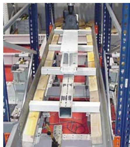
Figura 4. Ejemplo de ensayo de carril para paletización compacta.
