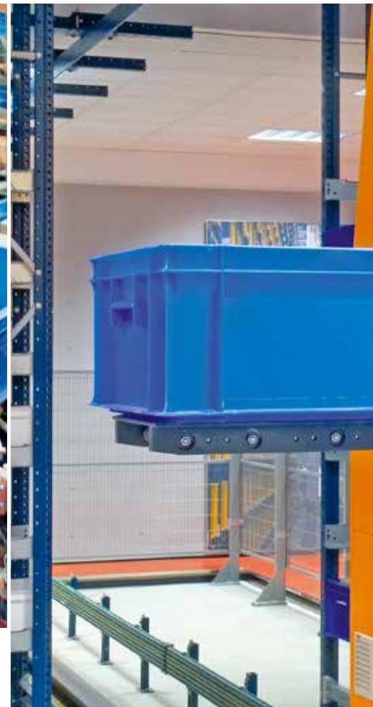
Sistema de extracción con palas para extraer dos cajas a la vez.
